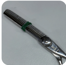
開いて刃が欠けないように 刃先を輪ゴムなどで固定
